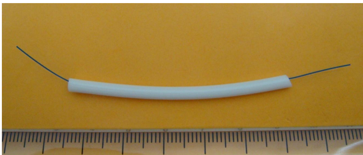
Figura 3 – Tubo de silicone com fio passado no seu interior.
