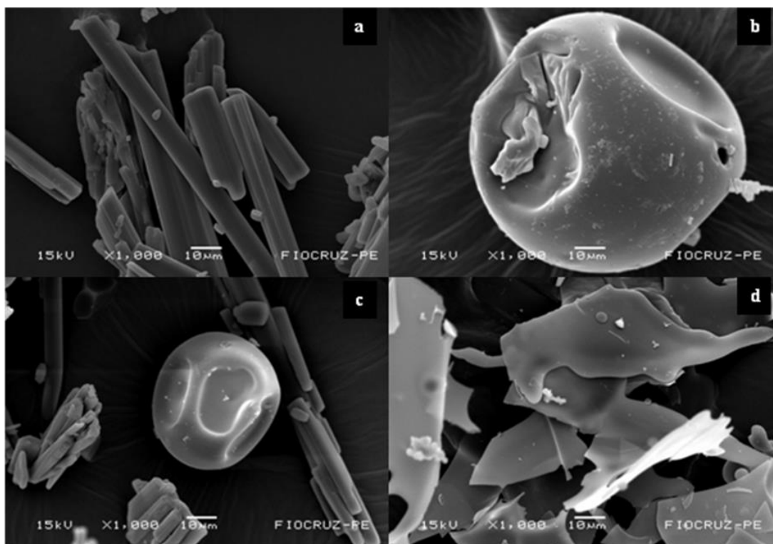
Figura 1 - Micrografia eletrônica de varredura do ácido gálico (a), HP \beta CD (b), mistura física (c) e complexo de inclusão AG:HP \beta CD (d). Magnificação de 1000x
