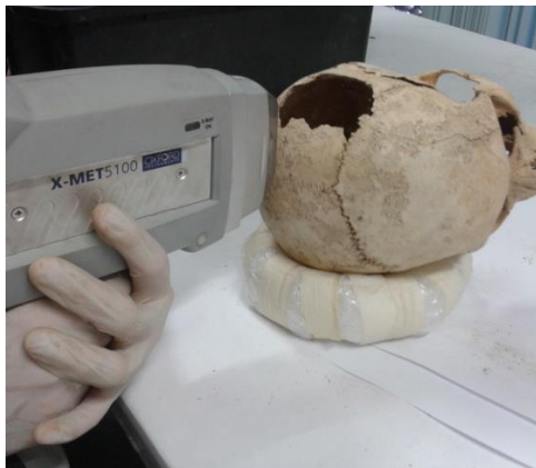
Figura 103: Análise realizada no crânio 44 com o equipamento portátil de Fluorescência de Raio X.
