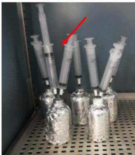
Para a segunda fase os gases foram coletados em bolsas (Figura 3.7), para facilitar a análise do gás e não precisar remover as bolsas em cada análise, foi inserido uma agulha nas mangueiras de conexões e retirados 10 mL de gás, seguindo assim o mesmo procedimento anterior para determinação da composição dos gases.
