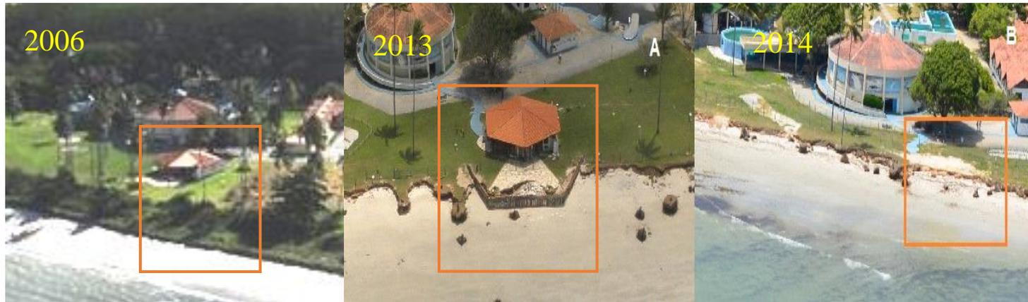
Figura 35: Área do Projeto Peixe Boi – ICMbio, em detalhe. Anos de 2011, 2013 e 2014. No ano de 2006 a construção em destaque situava-se a pelo menos 30 metros da linha de preamar; em 2013 essa mesma construção só estava de pé por conta de uma obra de contenção precária e em 2014 a construção havia sido demolida pelas ondas.
