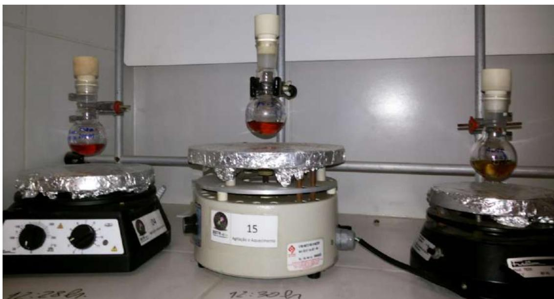
**Figura 6.1:** Balões de fundo redondo, 50,0 mL, presos no suporte universal submetido à agitação magnética, correspondendo aos ensaios em bateladas.
