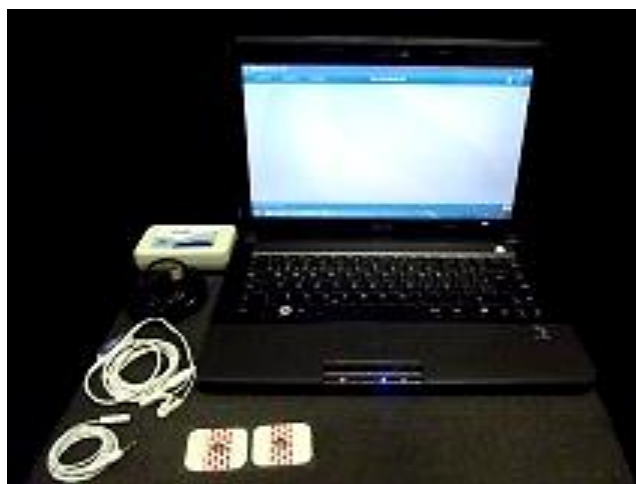
Figura 4 – Eletromiógrafo, sensores, cabos, eletrodos e microcomputador utilizados para aquisição do exame eletromiográfico da mastigação.
