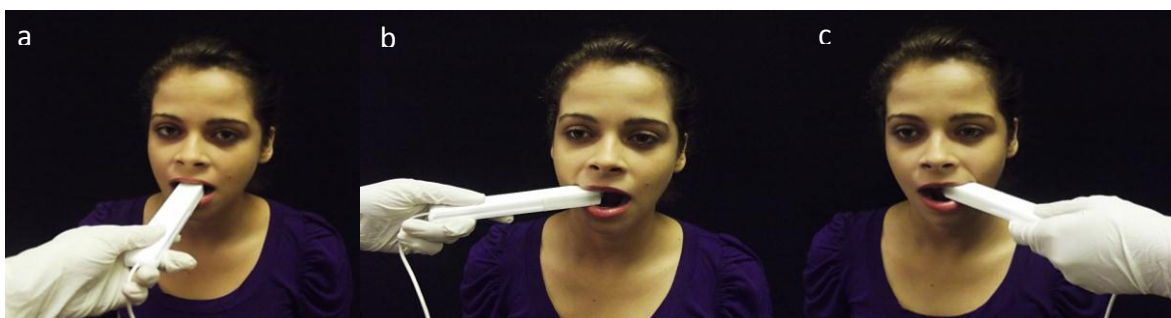
Figura 2 – Ilustração da aquisição de força de mordida: a) Aquisição da força de incisão; b) Aquisição da força de mordida entre os molares do lado direito; c) Aquisição da força de mordida entre os molares do lado esquerdo.
