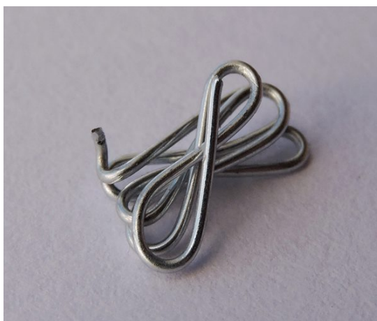
Figura 27 – Semelhante aos laços em duas dimensões, a figura mostra uma estrutura formada devido a torção acumulada no fio.
