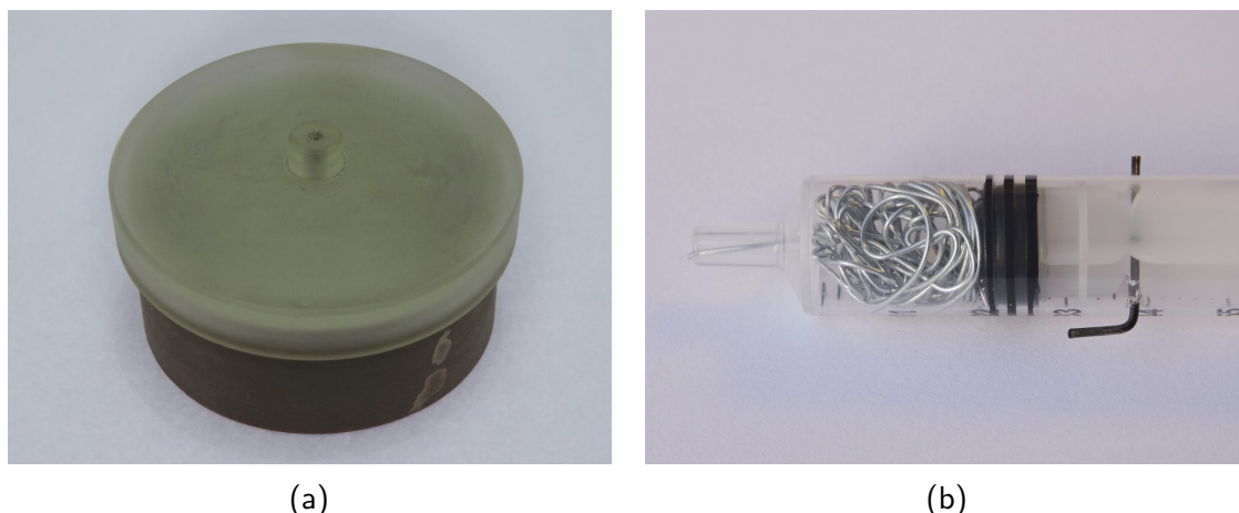
Figura 26 – (a) uma das cavidades de PVC usadas nos experimentos. (b) seringa de plástico mostrando o êmbolo e a capa de látex assim como o pino usado para travar o êmbolo. No interior da cavidade é possível ver o arame galvanizado inserido.
