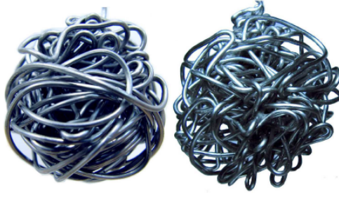
Figura 23 – Bolas de arame obtidas em regime de baixa fricção (esquerda) e alta fricção (direita) [37].
