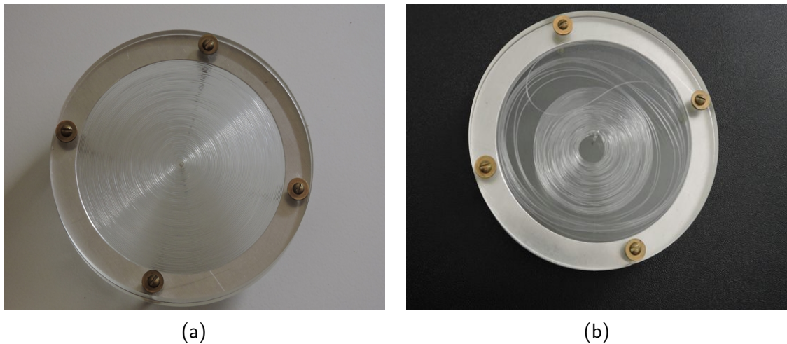
Figura 51 – Arame de 0,6mm de diâmetro inserido em uma cavidade de 1mm de altura é mostrado em (a). Na figura (b) vemos um laço formado no empacotamento até o congestionamento de um fio de nylon de 0,5mm de diâmetro na mesma cavidade. A injeção é feita através de um canal no centro de uma das superfícies de acrílico.
