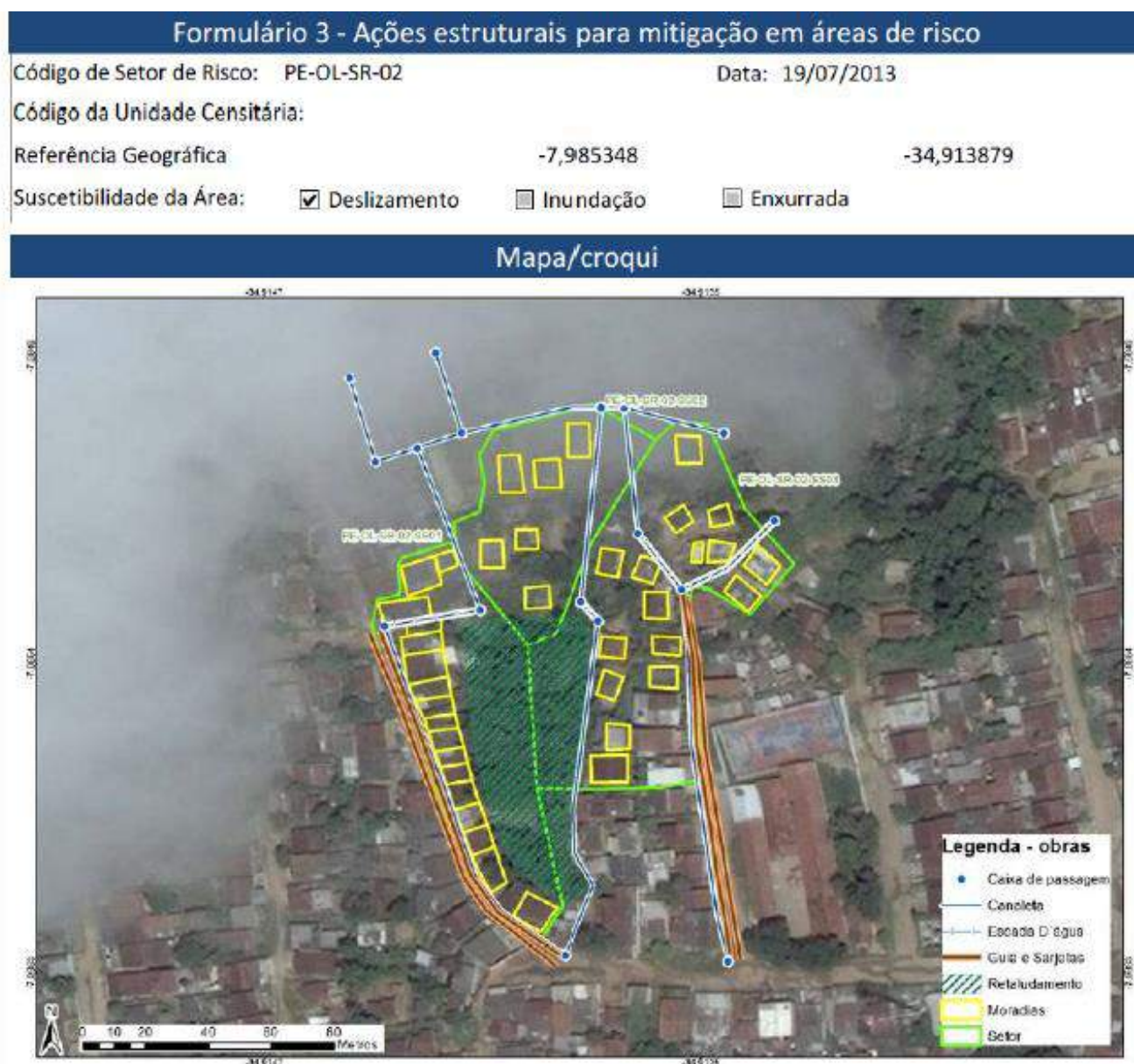
Figura 7.9 – Intervenções sugeridas no setor PE-OL-SR-02.
