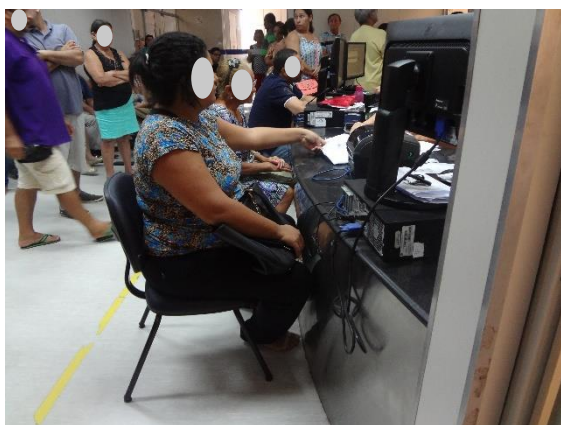
Figura 134 – Mobiliário de atendimento sem área de aproximação.
