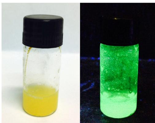
**Figura 5.19** – Imagem dos bioconjugado CdTe/CTM-anti-NS1 DENV e do mesmo sistema sob excitação no UV ( $\lambda = 365\text{nm}$ ).
