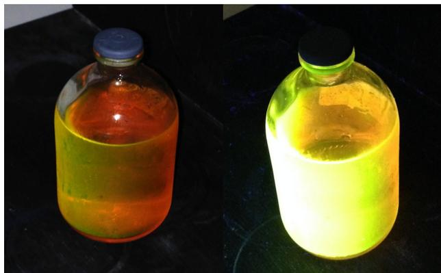
**Figura 5.5** – Fotografia da suspensão de CdTe/CTM utilizada para o desenvolvimento do fluoroimunoensaio. À esquerda observa-se o resultado direto da síntese e à direita observa-se o mesmo sistema sob excitação no UV ( $\lambda = 365$  nm).
