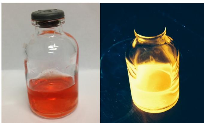
**Figura 5.3** – À esquerda observa-se uma imagem do resultado da obtenção de sistema coloidal contendo CdTe/MSA à direita uma imagem do mesmo sistema sob excitação no UV ( $\lambda = 365 \text{ nm}$ ).
