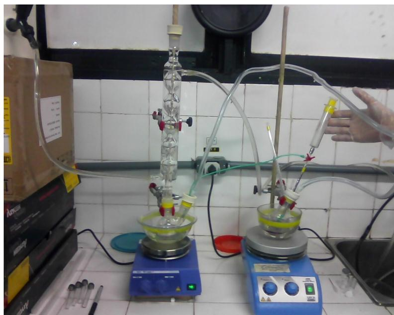
**Figura 4.3** – Aparato experimental empregado nas sínteses de CdTe em meio aquoso.
