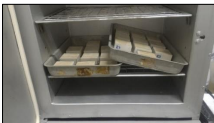
Figura 3 - Índices físicos: secagem das amostras em estufa
