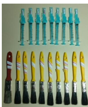
Figura 14 – Resistência ao ataque químico: pincéis e seringas de aplicação
