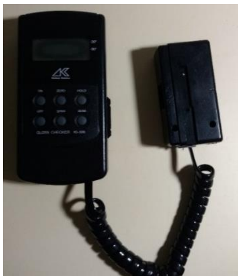
Figura 16 - Resistência ao ataque químico: gloss checker IG330 Sanwa Kenma
