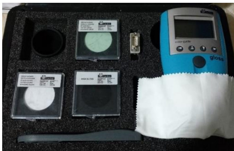
Figura 15 - Resistência ao ataque químico: espectrofotômetro color-guide BYK Gardner
