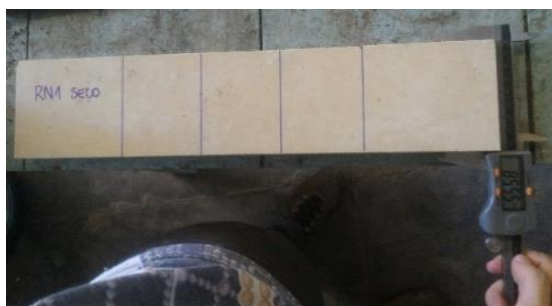
Figura 9 - Ensaio de flexão: marcação e medição das amostras
