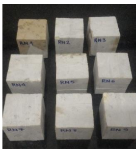
Figura 6 - Ensaio de compressão simples: amostras utilizadas
