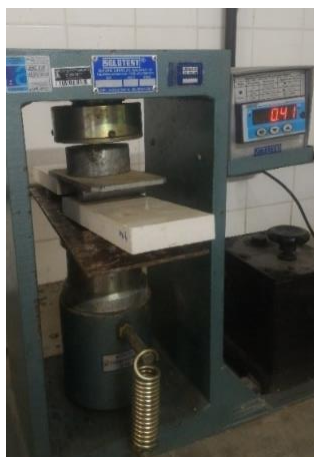
Figura 10 - Ensaio de flexão: equipamento utilizado
