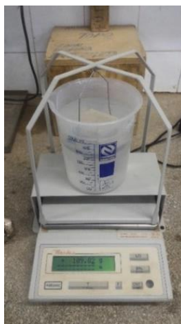
Figura 5 - Índices físicos: pesagem de massa submersa
