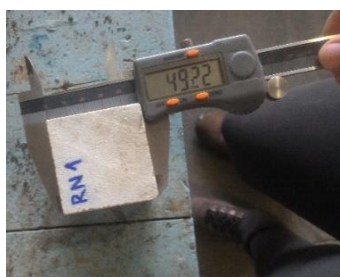
Figura 7 – Ensaio de compressão simples: medição das amostras
