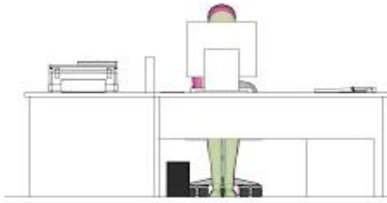
Figura 37 - VISTA FRONTAL EXTERNA – interseção dos Percentis 2,5 e 97,5
