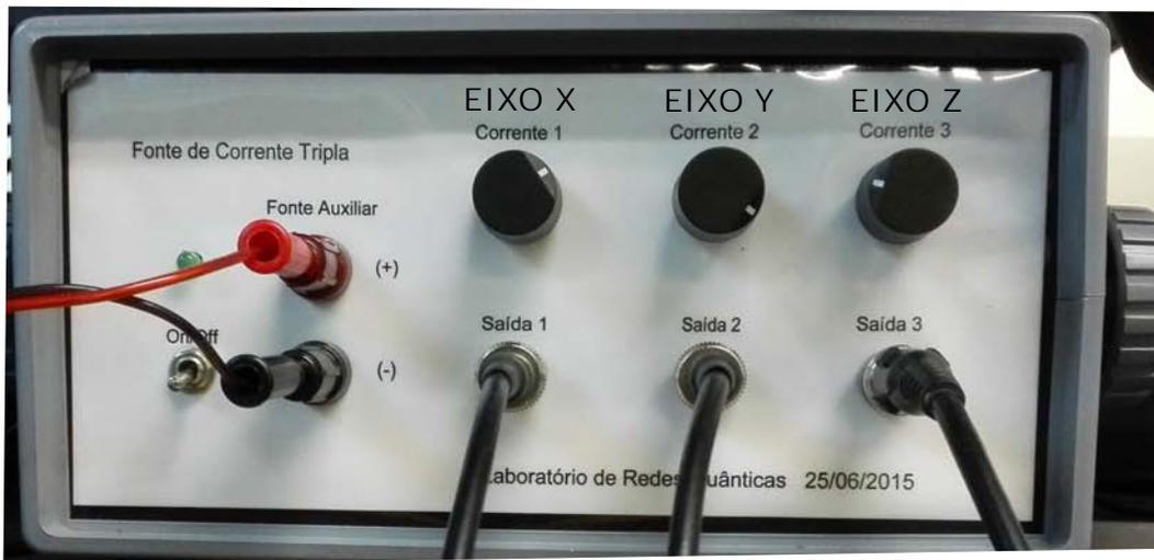
Figura 3.18: Foto do painel de controle de corrente das bobinas de compensação.
