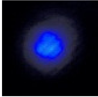
Figura 3.9 Imagem da seção reta do feixe. Neste caso temos um exemplo do perfil espacial na posição central da célula, quando esta é retirada.
