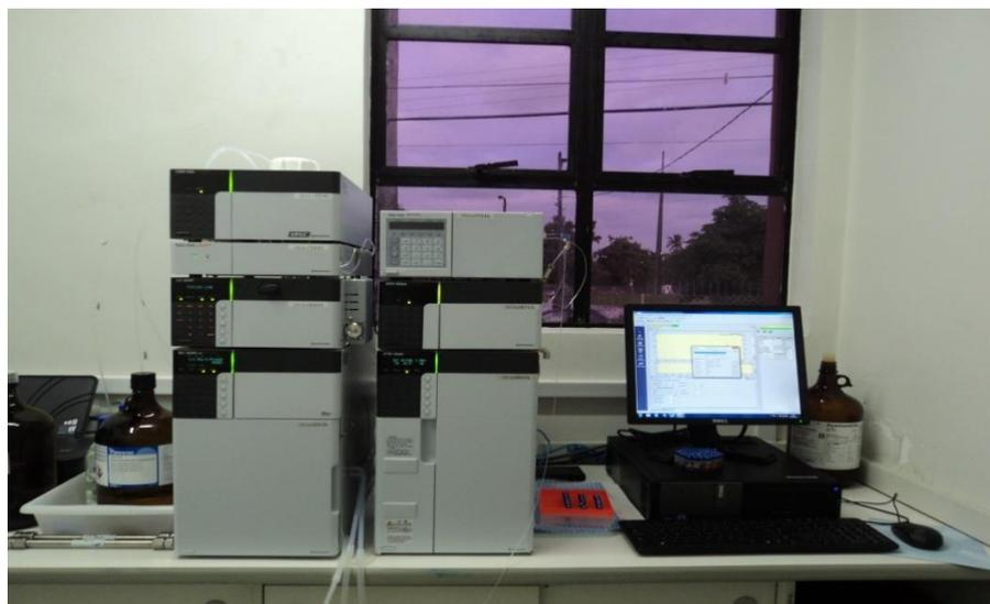
**Figura 1.4:** Cromatógrafo líquido de alta eficiência acoplado ao detector de arranjo de fotodiodos.
