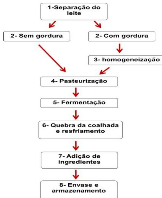
**Figura 1.1:** Fluxograma básico do processo de produção de iogurte e bebidas lácteas. <sup>18,19</sup>
