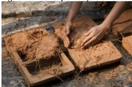
Figura 40: Fabricação de tijolo em adobe.
