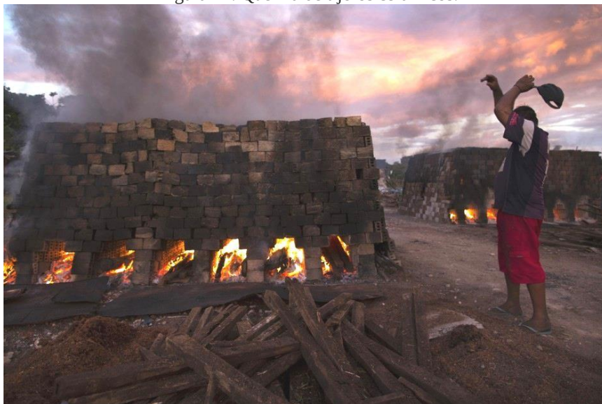
Figura 44: Queima de tijolos cerâmicos.
