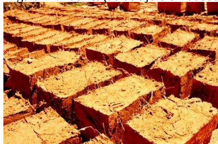
Figura 41: Fabricação de tijolo em adobe.
