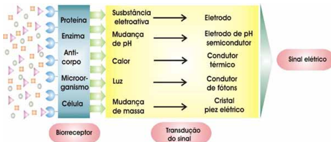
Figura 09: Representação esquemática do princípio do biossensor.
