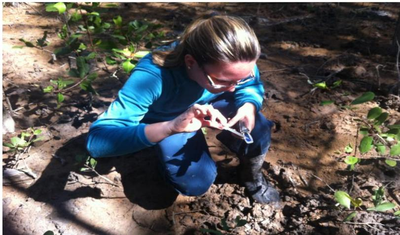
Figura 15: Leitura *in situ* da salinidade intersticial, com o auxílio do refratômetro óptico, no manguezal do rio Tabatinga, Suape, PE.
