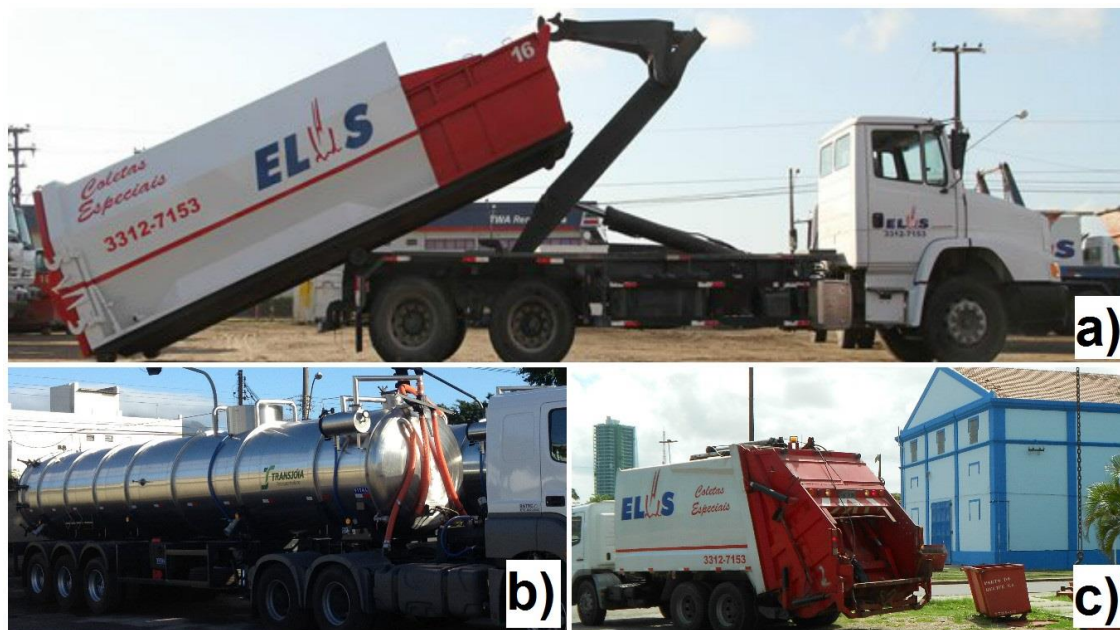
Figura 11 – Tipos de Caminhões Coletores: a) Combopac de caminhão Roll On Roll Off ; b) caminhão sugador; e c) caminhão compactador
