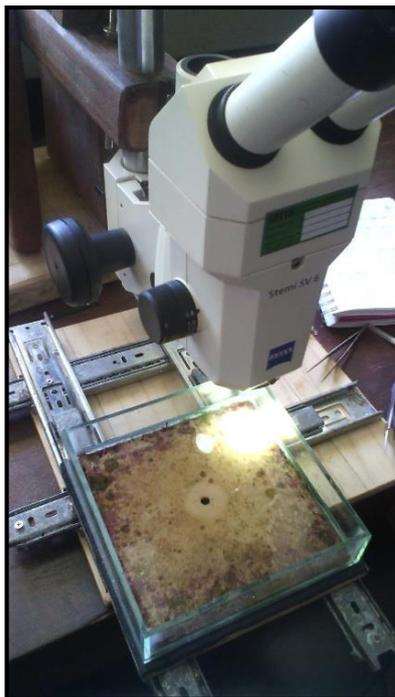
Figura 06: Lupa estereoscópica com mesa adaptada para análise.
