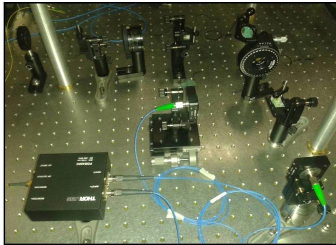
Figura 3.15: Aparato experimental empregado para a medição de ruído quântico.
