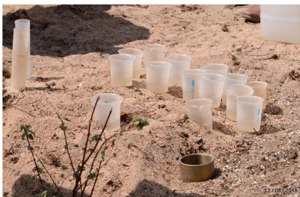
Figura 2. 7 – Ensaio de infiltração com anel simples.
