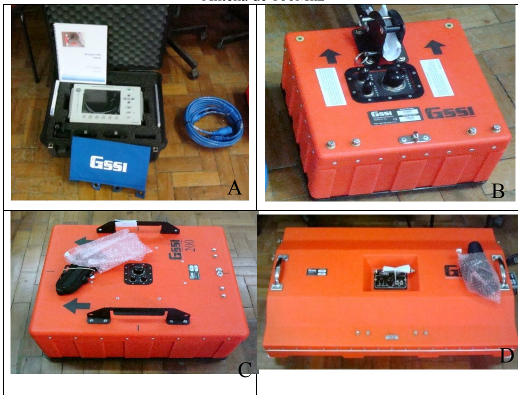
Figura 3. 11 – A) Sistema de aquisição de dados; B) Antena de 400Mhz; C) Antena 200 Mhz, D) Antena de 100Mhz
