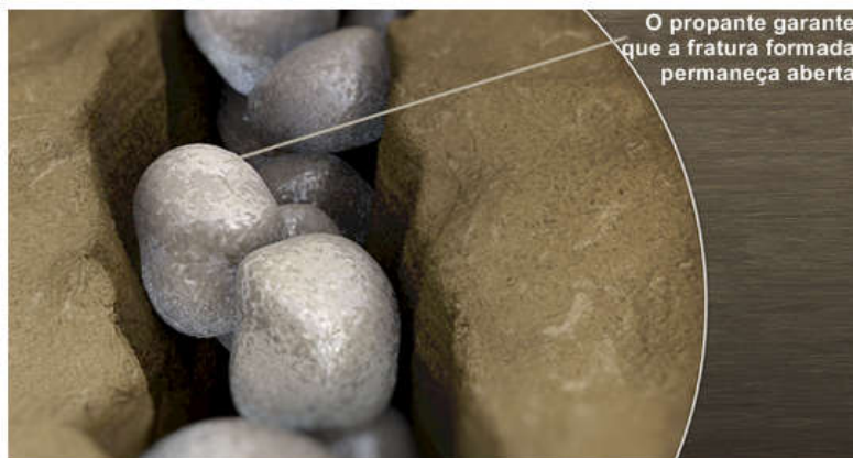
Figura 2.7 – Visualização do propante dentro da fratura.
