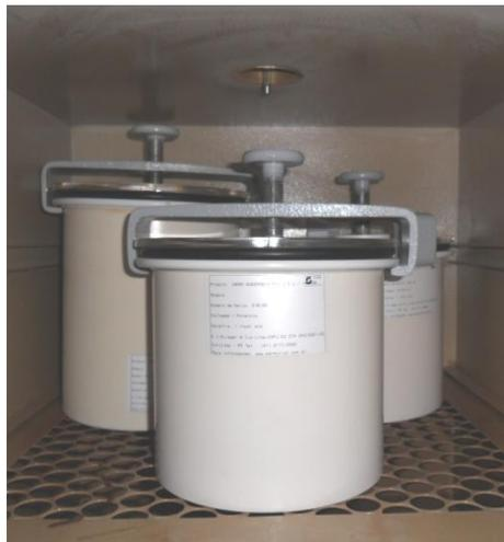
Figura 8 - Jarras de anaerobiose usadas para incubação das placas.
