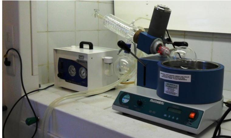
Figura 7 - Evaporador rotativo a vácuo utilizado no preparo de lipossomas contendo *B. lactis*
