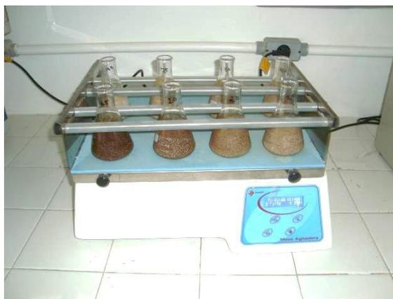
**Figura 5:** Mesa agitadora com experimento em andamento
