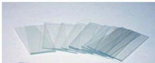
Figura 14: Lâminas de ITO retangulares em substrato de vidro. Fore Vision Instruments.<sup>96</sup>
