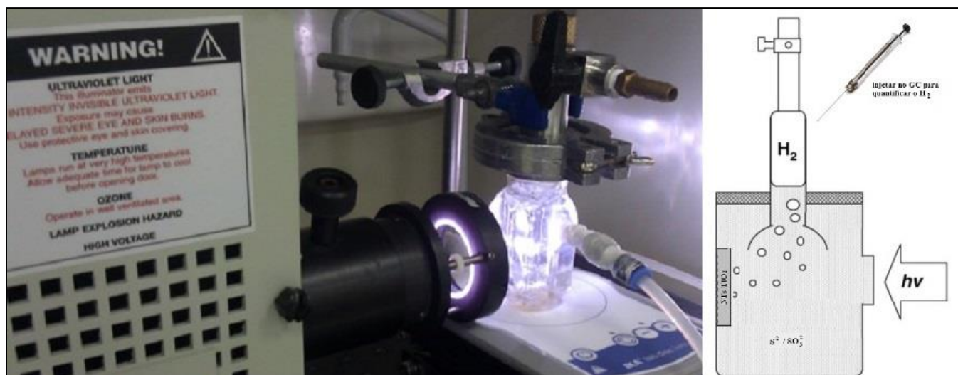
Figura 3.5. Sistema real e esquemático para geração de \text{H}_2 a partir da fotocatalise.
