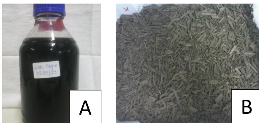
Figura 20. Licor negro obtido da reação de deslignificação (A); Polpa celulósica (B).
