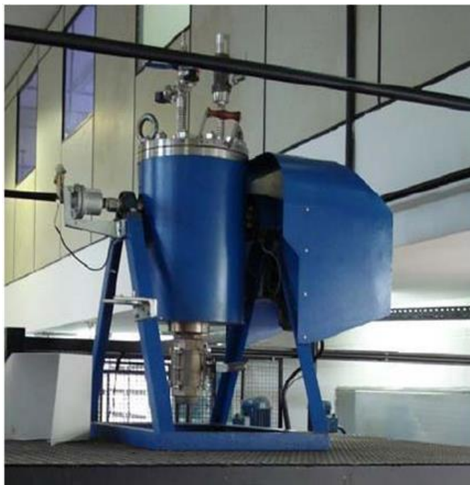
Figura 18. Foto do reator rotatório (Regmed AU/E-20) onde foi realizado o pré-tratamento hidrotérmico e deslignificação alcalina.
