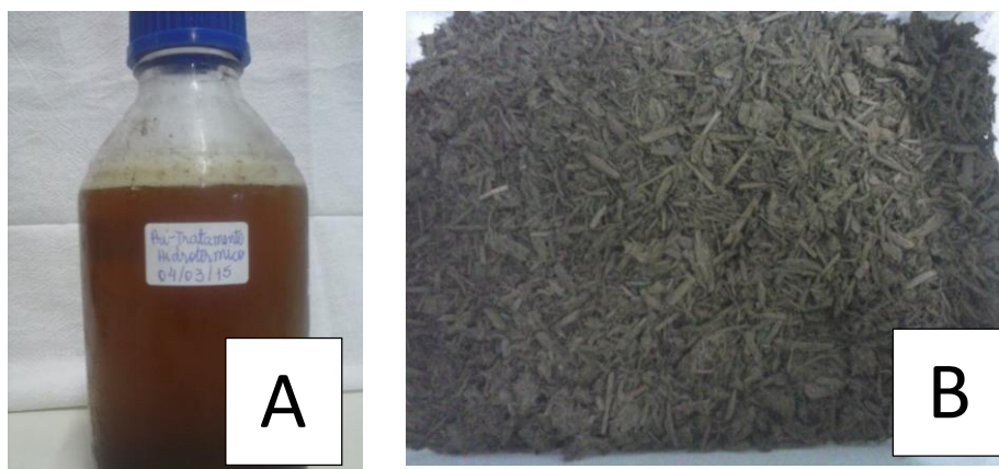
Figura 19. Hidrolisado hemicelulósico obtido no pré-tratamento hidrotérmico (A); fração sólida obtida após o processo (B).
