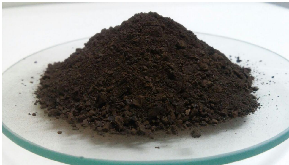
Figura 21. Lignina precipitada com ácido sulfúrico.
