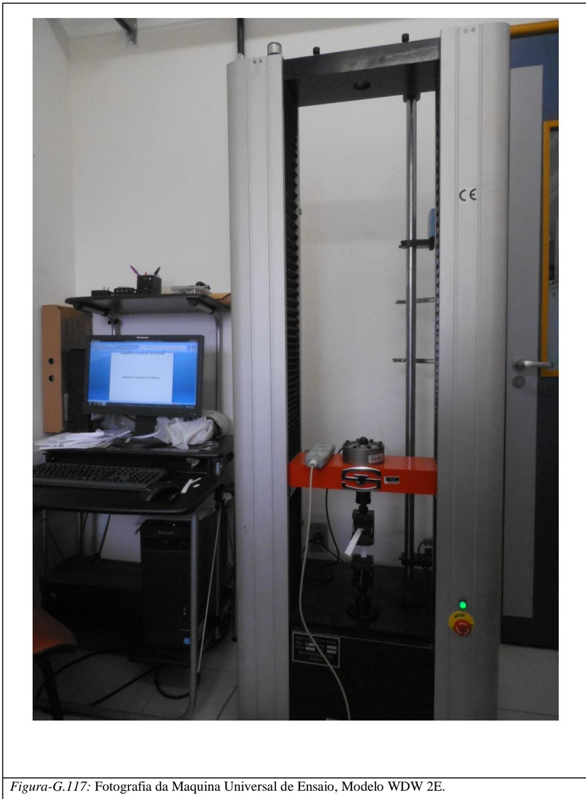
*Figura-G.117: Fotografia da Máquina Universal de Ensaio, Modelo WDW 2E.*
