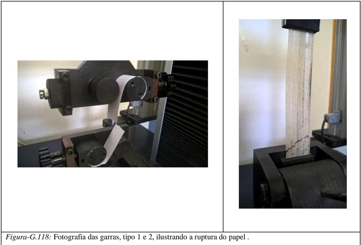
*Figura-G.118:* Fotografia das garras, tipo 1 e 2, ilustrando a ruptura do papel .
