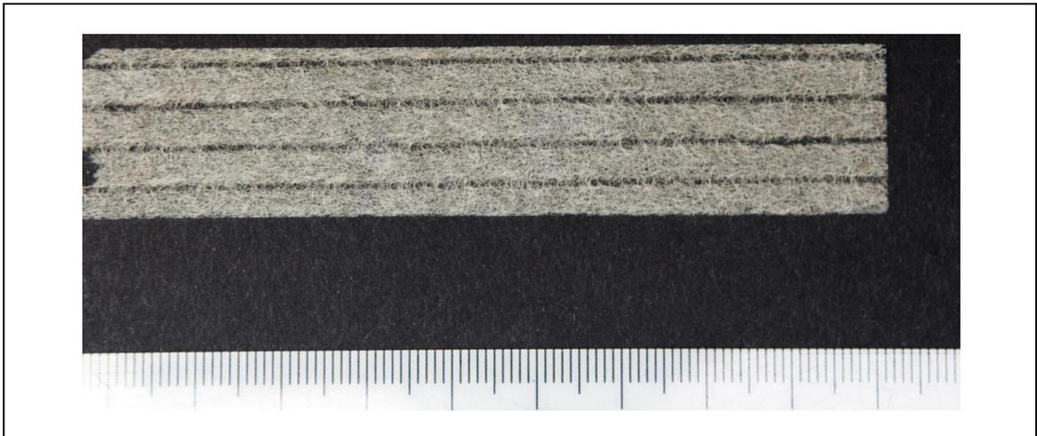
*Figura-E.99:* Fotografia da amostra do Papel Sudare com 504 horas.
