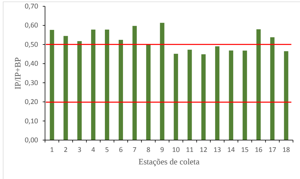
Figura 30 - Razão entre indeno[1,2,3-cd]pireno e indeno[1,2,3-cd]pireno + benzo[ghi]perileno (IP/IP+BP) nas 18 amostras de sedimento coletadas no canal principal do estuário do Rio Capibaribe. As linhas em vermelho correspondem aos limites de classificação da razão IP/IP+BP. Valores menores que 0,20 são típicos de fontes petrogênicas, valores entre 0,20 e 0,50 indicam fonte pirolítica oriunda da combustão de petróleo e derivados e valores maiores que 0,50 indicam fontes pirolíticas oriundas da combustão de biomassa vegetal e carvão mineral.
