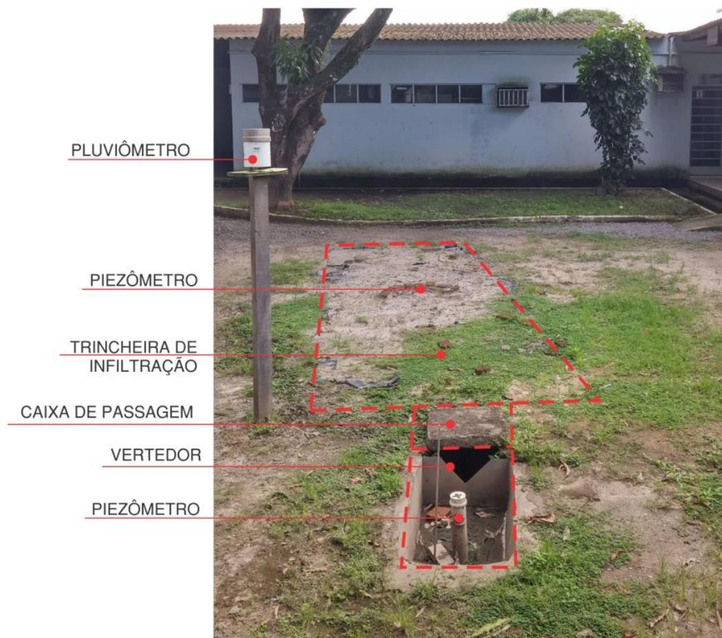
**Figura 3.4:** Implantação e instrumentação.
