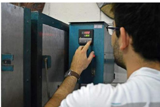
Figura 111 – Programação da temperatura do forno elétrico.
