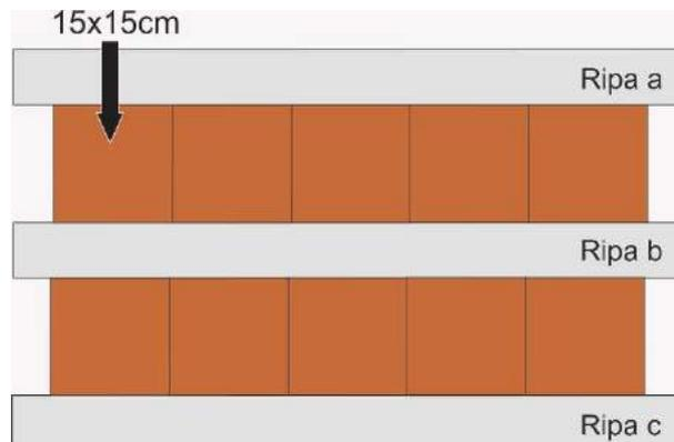
Figura 100 – Vista superior do posicionamento das ripas. Fonte: o autor.
