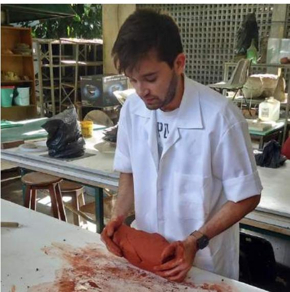
Figura 96 – Adensamento manual da argila.
