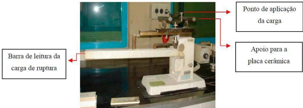
Figura 121 – Equipamento de medição da carga e módulo de ruptura à flexão.
