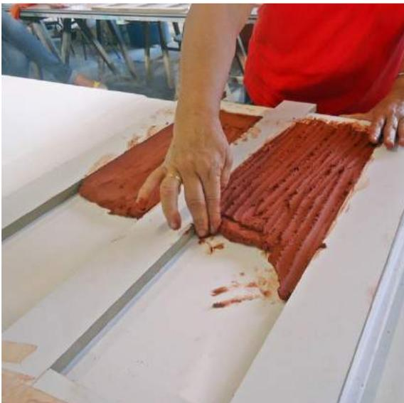
Figura 104 – O espaço é preenchido com a argila adensada, sendo colocada sobre pressão para evitar bolhas de ar.
