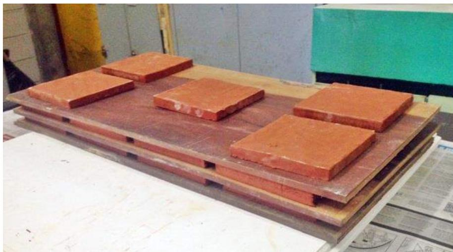
Figura 110 – Secagem das peças sobre tábuas de madeira. As peças são viradas diariamente durante o período da secagem, evitando a curvatura de suas extremidades. Fonte: o autor.
