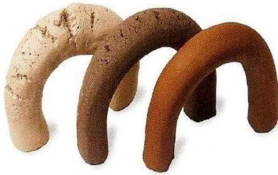
Figura 94 – Rolos de argila apresentando rachaduras, necessitando de maior adensamento. Fonte: Frigola (2005)
