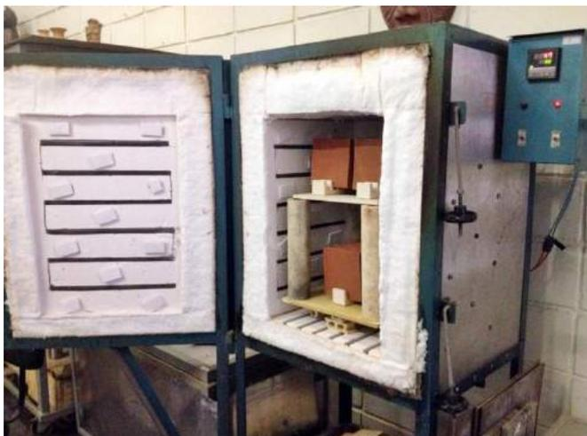
Figura 115 – Biscoitos inseridos no forno elétrico.
