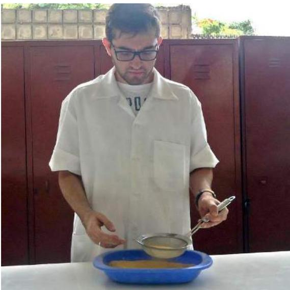
Figura 84 – Peneiramento de toda matéria-prima com a peneira granulométrica de 100 mesh.
