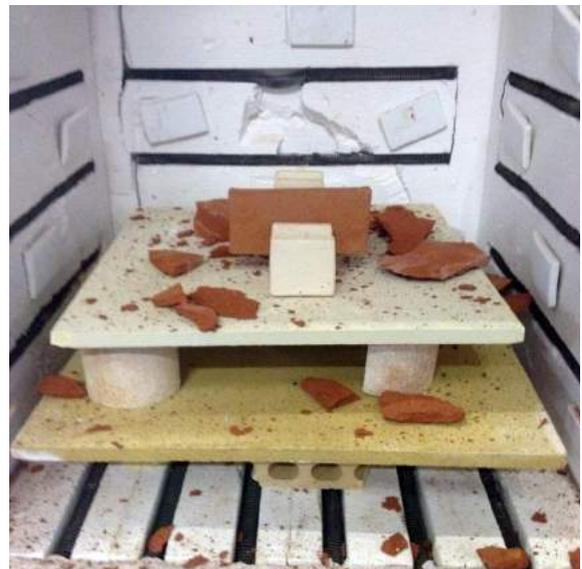
Figura 114 – Resultado da queima experimental com explosão da peça em decorrência do aumento brusco de temperatura.
