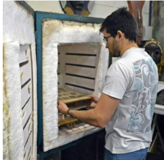
Figura 77 - Inserção das peças no forno elétrico, apoiadas sobre placa de cordierita.
