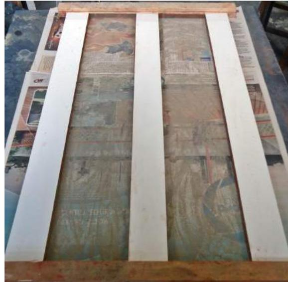
Figura 103 – Uma fina camada de areia é colocada para evitar aderência da argila na base da moldagem.
