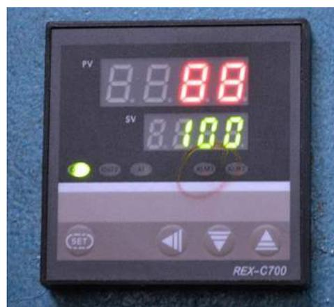
Figura 112 – Detalhe: termostato REX-C700. Os dígitos em vermelho indicam a temperatura interna do forno; os dígitos laranja indicam a temperatura programada.
