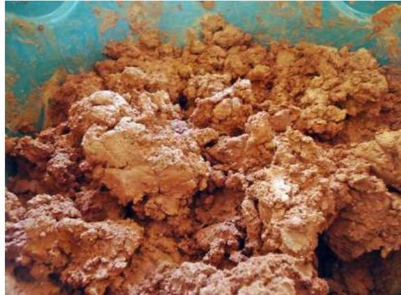
Figura 93 – Massa já misturada, a ponto de passar para a etapa de adensamento.
