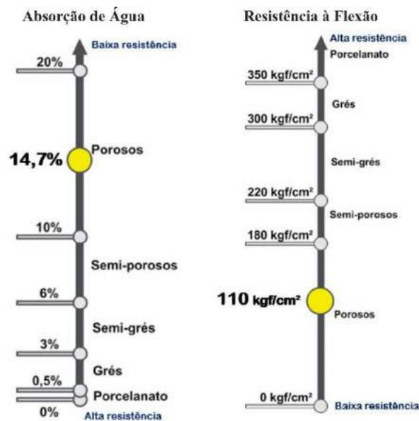
Figura 131 – Resultado médio da absorção de água e resistência à flexão dos corpos de prova resultantes da reprodução tecnológica dos azulejos históricos da fase 2.
