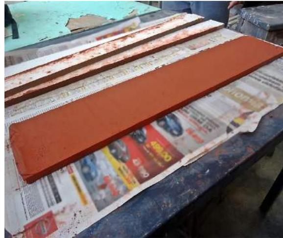
Figura 107 – Remoção das ripas de madeira, para corte das peças.
