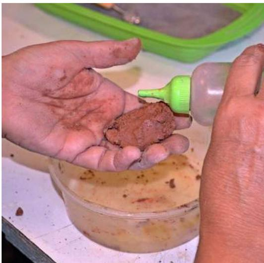
Figura 72 – Mistura com água.
