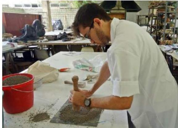
Figura 83 – Argila cinza triturada manualmente com pistilo.
