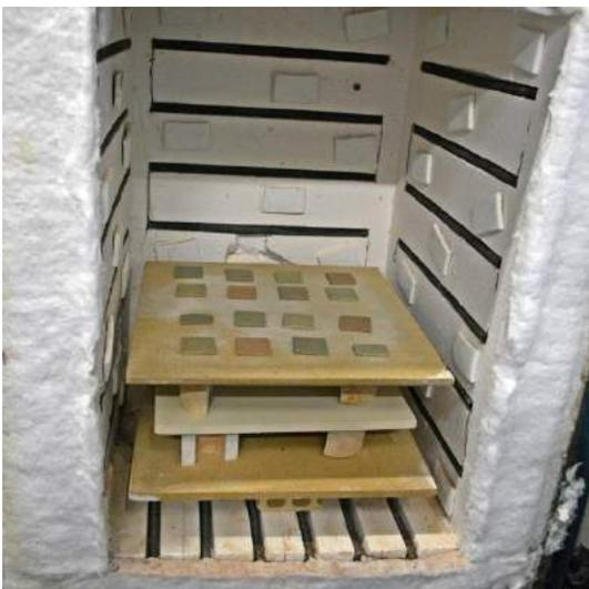
Figura 78 – Queima controlada em forno elétrico.
