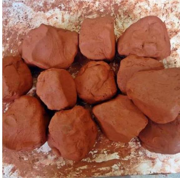
Figura 99 – Massa de argila pronta para modelagem.
