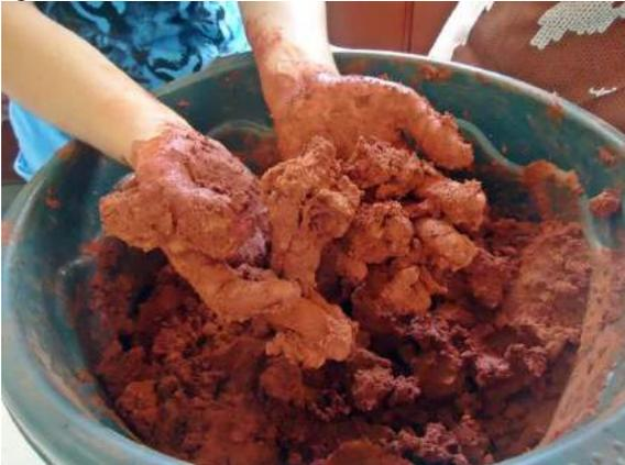
Figura 92 – Verificação do ponto de liga da mistura.
