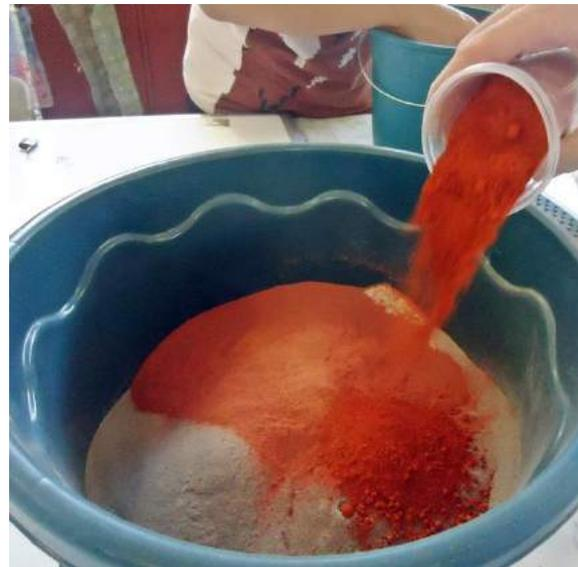
Figura 87 – Adição do óxido de ferro na mistura.
