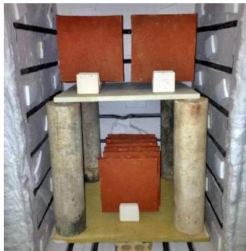
Figura 116 – Detalhe da arrumação das peças no forno apoiadas com o suporte dentado.
