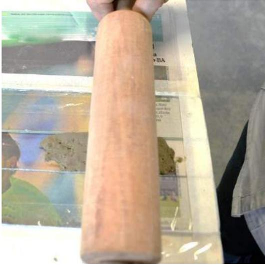
Figura 74 – Moldagem com rolo de madeira.
