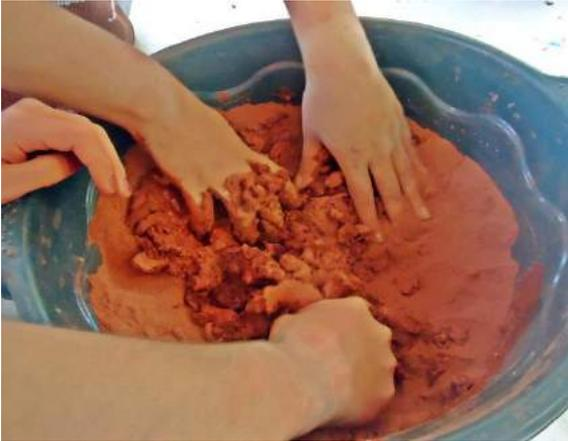
Figura 90 – Mistura manual, com adição gradual de água.
