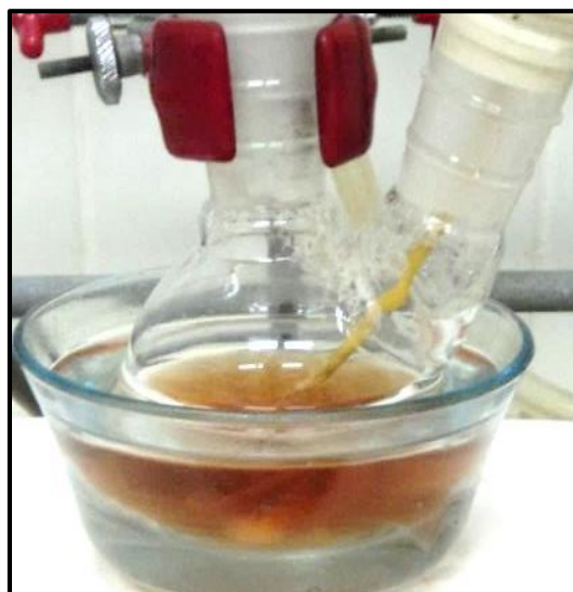
Figura 19: Produto final da síntese dos QDs de CdTe-TGA com proporção de 1:4:9,6.
