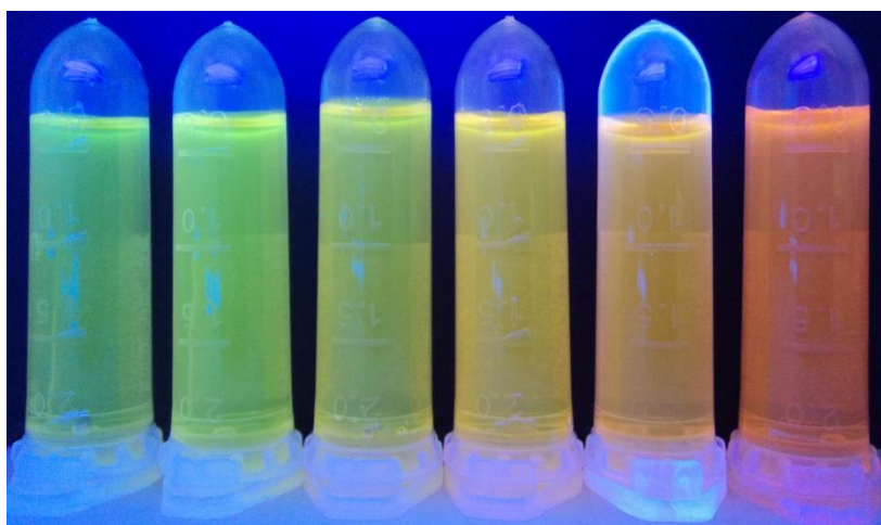
Figura 20: QDs de CdTe após tratamento térmico de 0,5 h a 3 h a luz ambiente e sobre excitação de luz UV ( \lambda_{\text{exc}} = 365 \text{ nm} )
