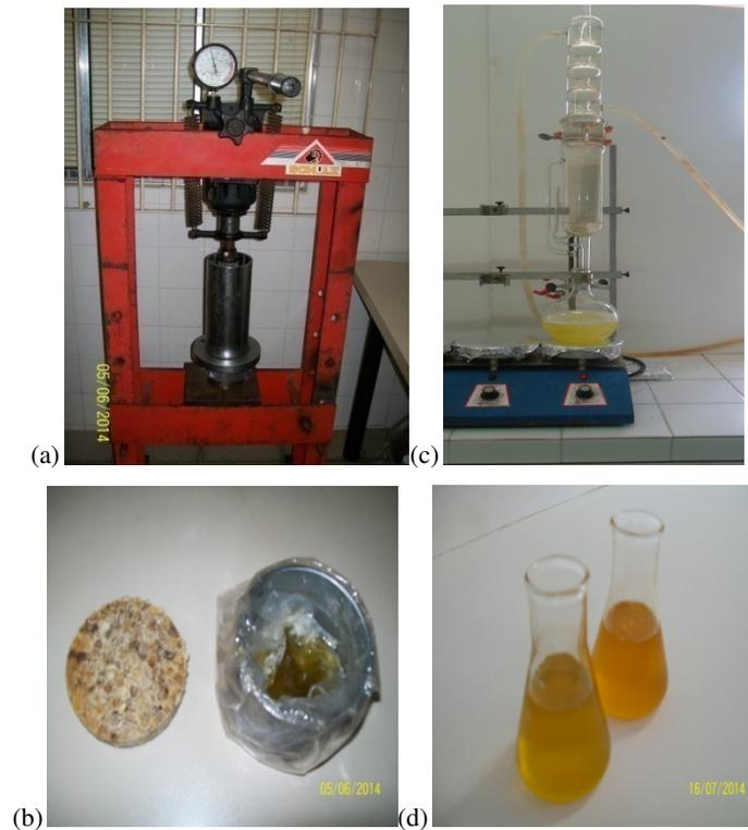
(a) Prensa hidráulica manual com extrator em operação (b) Torta de prensagem e copo receptor do extrator com óleo (c) Extrator de Soxhlet usado em operação (d) Óleos brutos de moringa por prensagem (frente) e por solvente (fundo).
