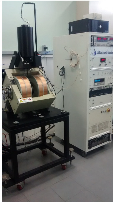
Figura 7.1: VSM utilizado para as medidas magnéticas.
