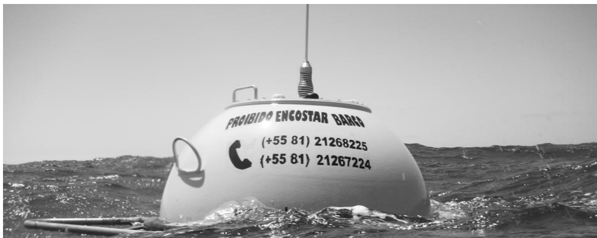
Figura 5.1 - Ondógrafo Waverider MKIII utilizado para o experimento.
