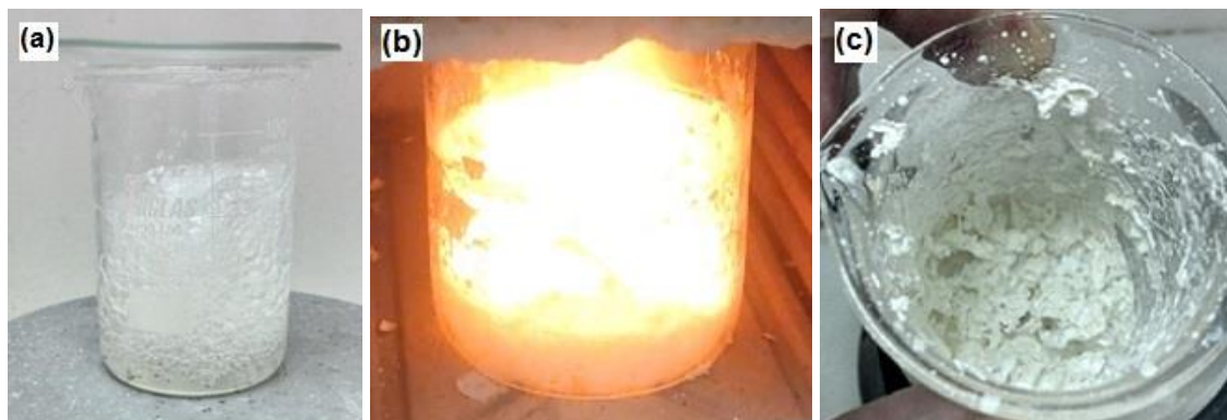
Figura 21 – Etapas da combustão: (a) evaporação, (b) combustão, (c) produto final.
