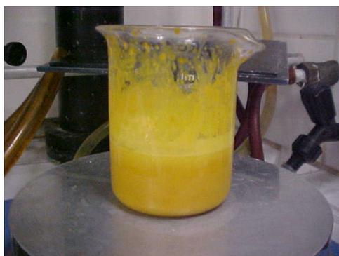
**Fig. 14 - Preparação da argila organofílica com íons  $\text{Fe}^{3+}$ , utilizando uma solução de  $\text{FeCl}_3$ .**
