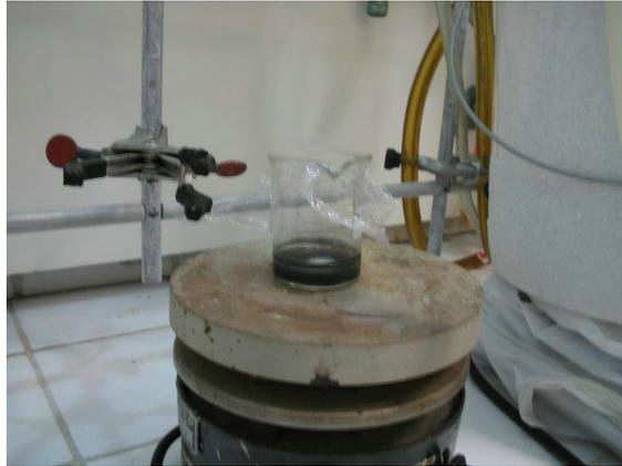
**Fig.13 - Preparação do nanocompósito por evaporação de solvente.**
