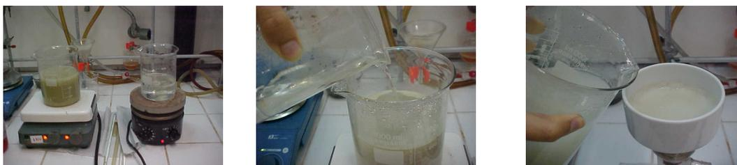
**Fig.11- Preparação da argila organofilizada: (a) chapas aquecedoras com respectivas dispersões da argila e solução do sal de amônio, (b) transferência das soluções para um mesmo béquer, (c) filtração do material após tempo previsto.**
