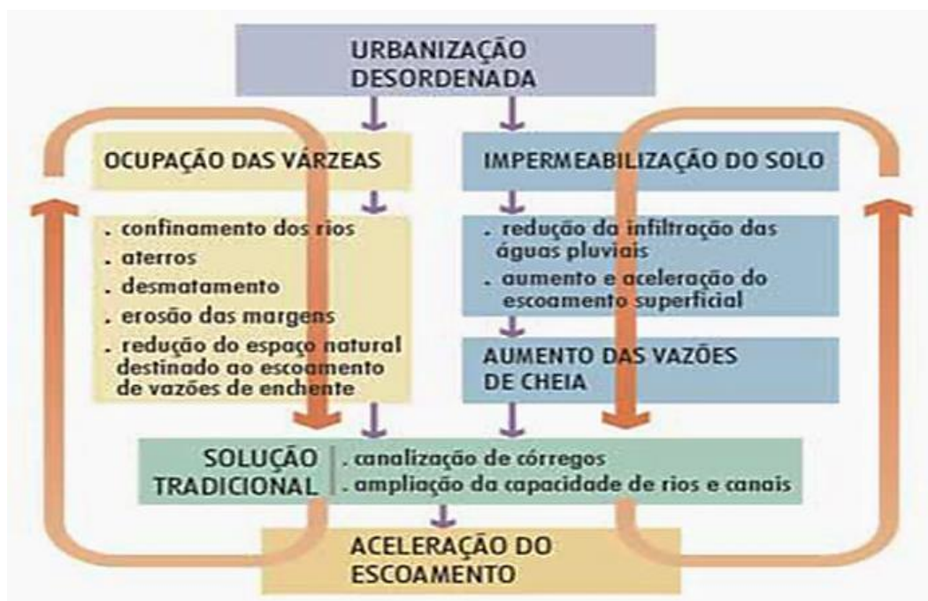
Figura 1: Mecanismo de controle do impacto da drenagem urbana no escoamento, (Tucci, 2004).
