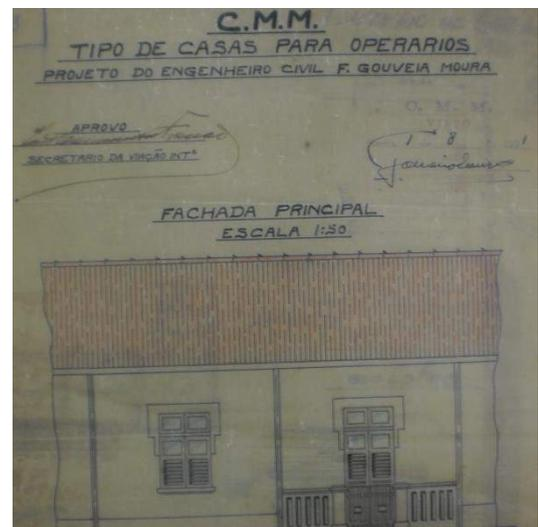
Figuras 27 e 28. Planta e fachada do projeto de F. Gouveia Moura para casas operárias geminadas, com 59,82m<sup>2</sup> cada unidade. Fonte: APEJE.
