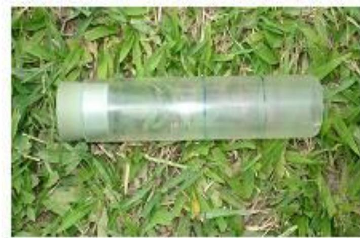
Imediatamente após a extração dos sedimentos, todas as amostras foram acondicionadas em recipientes plásticos devidamente identificados e imersos no formaldeído a 4% para sua preservação até o momento de sua extração (Figura 4.10).
