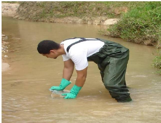
Logo após, os reservatórios de água devidamente cheios (aproximadamente 2 L) são acoplados ao cilindro, sendo inserido nas condições ambientais locais como temperatura do rio, nível da lâmina d'água, possíveis correntezas e mesma carga hidráulica (Figura 4.4).
