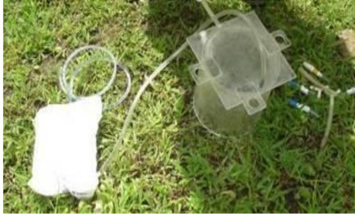
Os cilindros têm a parte inferior aberta e são produzidos com acrílico, onde sua área transversal é de 50,265 cm<sup>2</sup>. Para os reservatórios de água foram utilizadas bolsas hospitalares plásticas com capacidade para aproximadamente 2 L.
