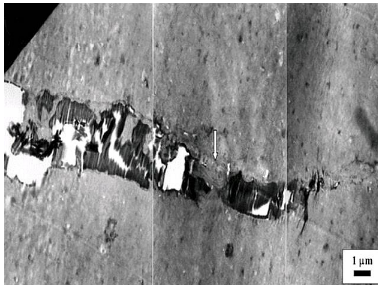
Figura 2. Imagem de MEV mostrando craze e trinca em amostra de blenda de PE/EVA que falharam após teste de ESCR a 50 °C.
