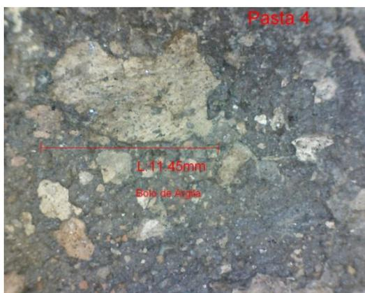
**Fig. 6:** Imagem aumentada 30 vezes com microscópio digital ISM-PRO, detalhe do bolo de argila.
