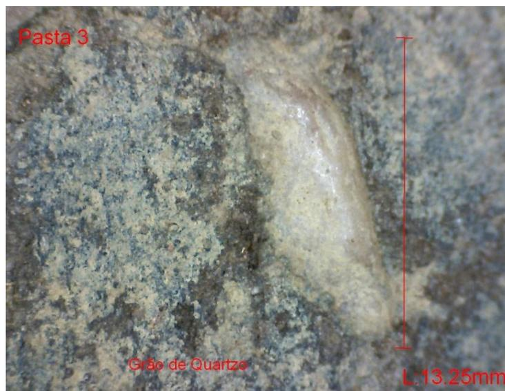
**Fig. 5:** Imagem aumentada 30 vezes com microscópio digital ISM-PRO, detalhe do grão de quartzo.
