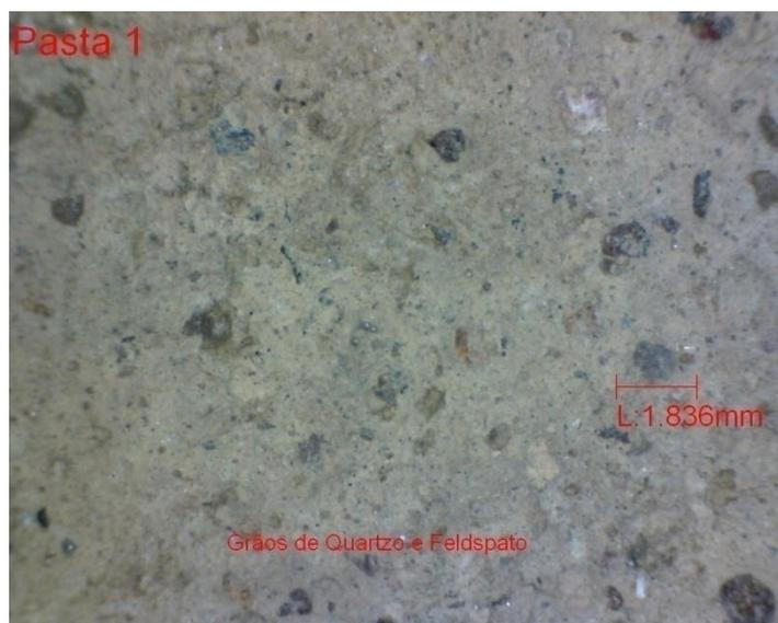
**Fig. 3:** Imagem aumentada 30 vezes com microscópio digital ISM-PRO, detalhe dos grãos de quartzo e feldspato.
