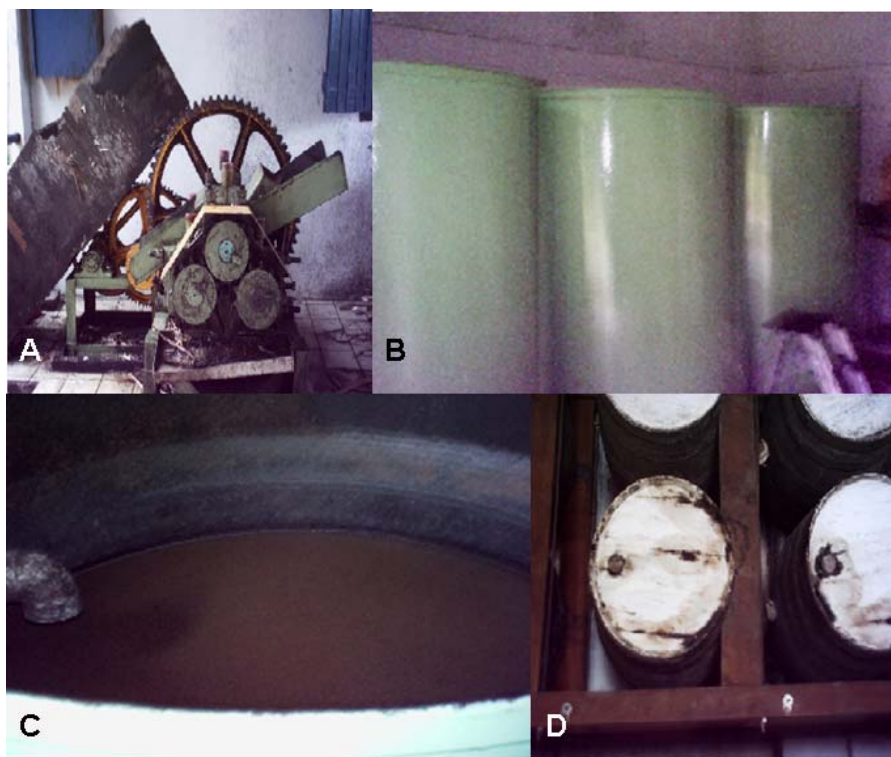
Figura 2. Alambique São Sarué - Igarassu/PE: A) Engenho de moer cana; B) Dorna metálica de fermentação; C) Fermento de corte; D) Barris de carvalho para envelhecimento da cachaça.
