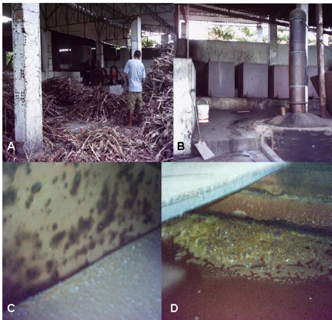
Figura 3. Alambique do Mirante da Cachaça – Paudalho/PE: A) Engenho de moer cana; B) Dornas de ferro de fermentação e destilador de ferro; C) Dorna de ferro; D) Fim da fermentação.
