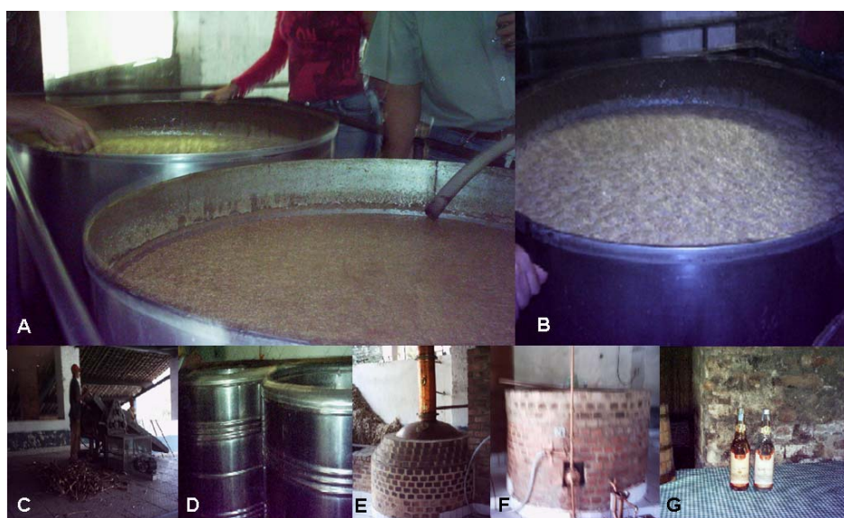
Figura 1. Alambique do Engenho Água Doce - Vicência/PE: A) Começo da fermentação; B) Fim da fermentação; C) Engenho de moer cana; D) Dorna de cobre de fermentação; E) Destilador; F) Alambique; G) Produto final da Cachaça.
