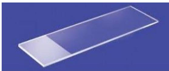
Figura 3. 2 - Placa de vidro utilizada como segundo substrato.
