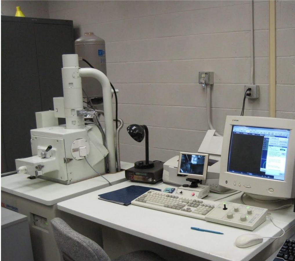
Figura 3. 6 - Microscópio Eletrônico de Varredura Jeol 5900.
