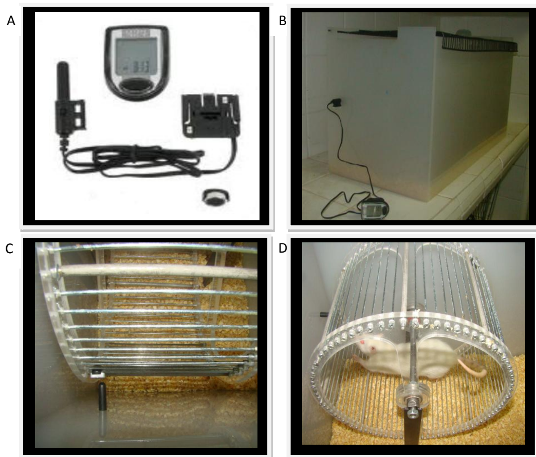
Figura 3. Esquema do funcionamento do ciclocomputador com os sensores [Cataye, model CC-VL810, Osaka, Japan] (A); Posicionamento de um sensor na porção externa da GAFV, acoplado ao ciclocomputador (B); visão interna dos sensores, um acoplado ao cicloergômetro e outro na GAFV (C); Rata realizando atividade física (D).
