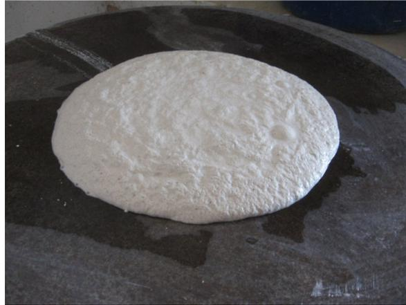
**Figura 1-** Argamassa com o uso do resíduo como pozolana e agregado miúdo na mesa de consistência.
