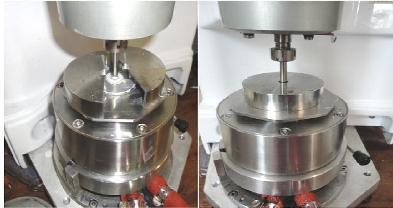
**Figura 3.19 –Detalhe esquemático dos cilindro coaxiais.**
