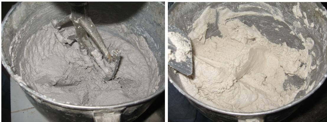
**Figura 5** - Aparência das argamassas: na esquerda usando areia e na direita usando o resíduo *in natura* (sem areia).
