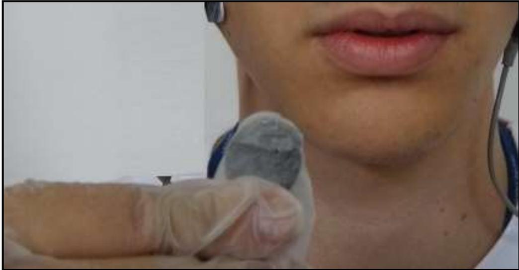
**Figura 4: Célula de carga protegida com dedeira de látex. FONTE: Modelo ilustrativo.**
