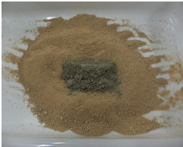
Figura 3.14 – Materiais proporcionalmente pesados e prontos para serem homogeneizados
