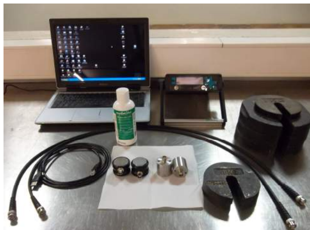
Figura 3.72 – Utensílios necessários para realizar o ensaio de ondas sísmicas com o instrumento ultrassônico Pundit Lab
