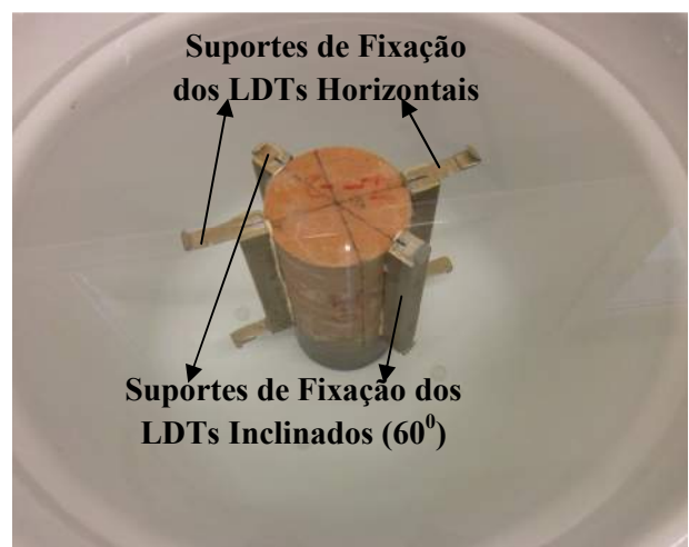
Figura 3.44 – Ensaio de tração por compressão diametral a) Vista lateral da disposição dos LDTs na base e no topo do corpo de prova e b) Imersão do CP após colagem dos suportes de fixação dos LDTs
