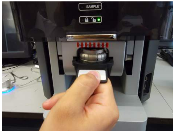
Figura 3.91 – Inserção do porta-amostra no SEM fabricado pela PHENOM
