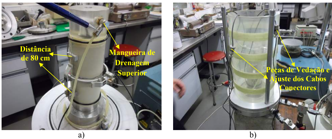
Figura 3.55 – Detalhes do fechamento da célula de carga: a) Mangueira de drenagem superior e b) Tampo de ajuste dos cabos dos transdutores
