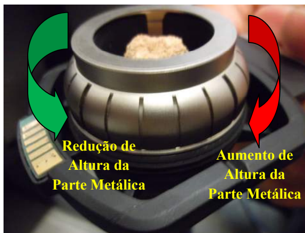
Figura 3.90 – Sentidos de ajustes do porta-amostra no MEV
