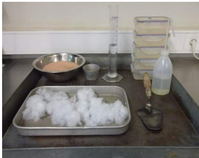
Figura 3.22 – Materiais utilizados para moldagem de um único CP de solo-cimento-fibra
