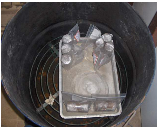
Figura 3.18 – Processo de cura dos corpos de prova de solo-cimento em reservatório úmido
