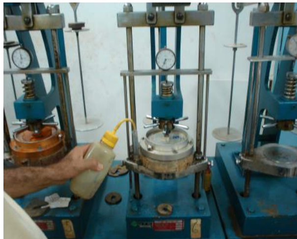
Figura 3.8 – Processo de inundação da amostra no ensaio de potencial de expansão e colapso
