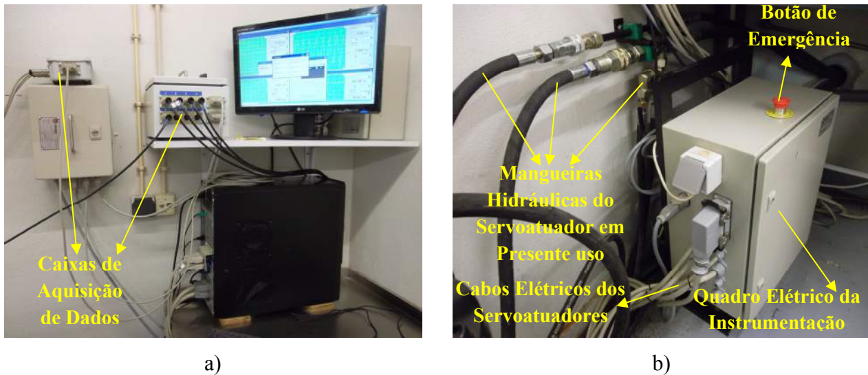
Figura 3.67 – Detalhes do sistema triaxial de aquisição da prensa: a) Computador de controle e b) Quadro elétrico da instrumentação
