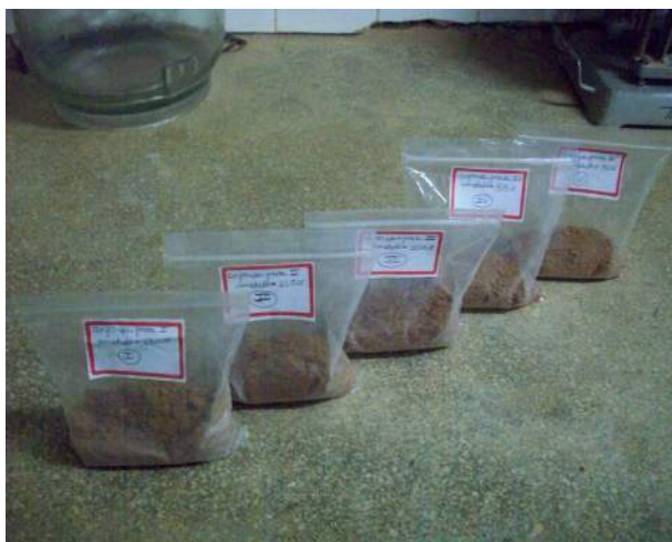
Figura 3.9 – Processo de armazenamento e identificação das amostras para o ensaio MCT
